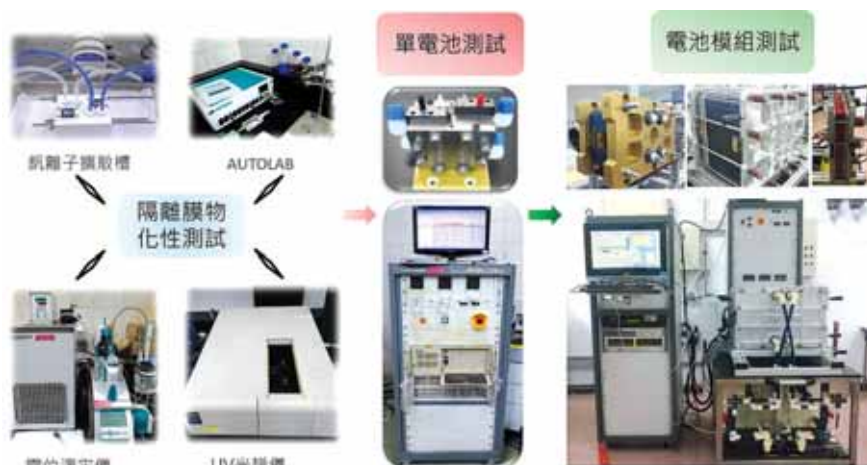
圖2. 隔離膜特性及效能測試裝置
