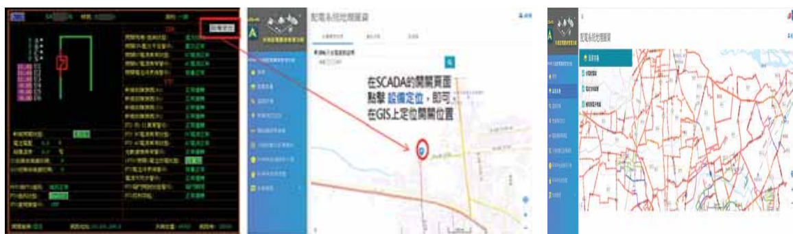
圖2. SCADA及GIS跨系統間互動定位功能
