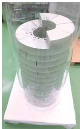
圖5. 不同離子強度水質對膨潤土膨脹之影響與中型膨潤土塊體展示模型
