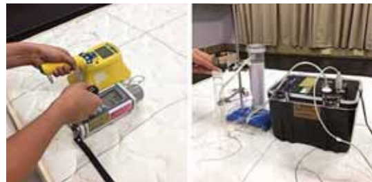
圖4. 負離子床墊量測之實況。分別依序為(a)核研所的氡氣量測實驗室、(b)以AT-1121量測床墊的表面輻射劑量、(c)以RAD7量測床墊所釋出的氡氣濃度
