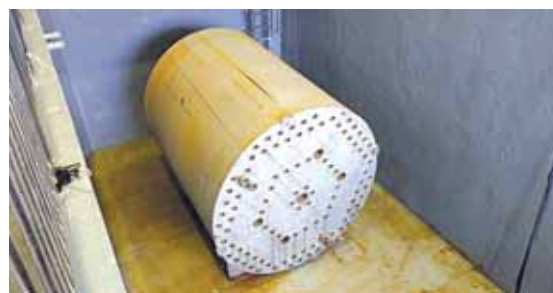
在TRR反應槽仿體上完成兩道模擬切割
