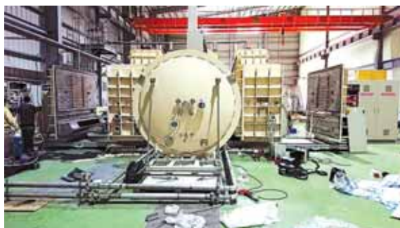
圖1. 合作廠商於斗六建置卷對卷複合型電漿模組化鍍膜系統。
