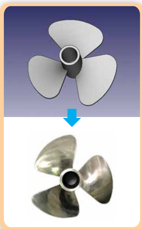
WAAM實現由3D圖檔直接輸出製造零件
