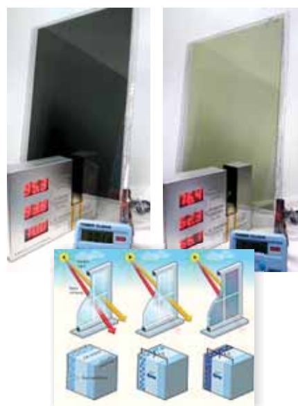
圖2. 上圖：自組研發智慧型電致變色膜 下圖：電致變色元件之原理
