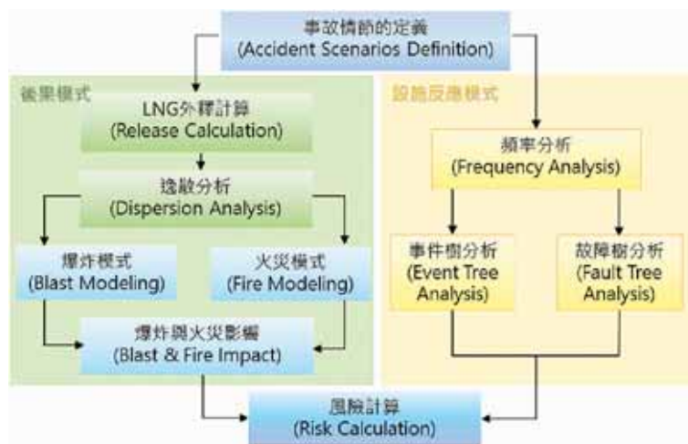
圖1. 液化天然氣接收站量化風險評估流程圖
