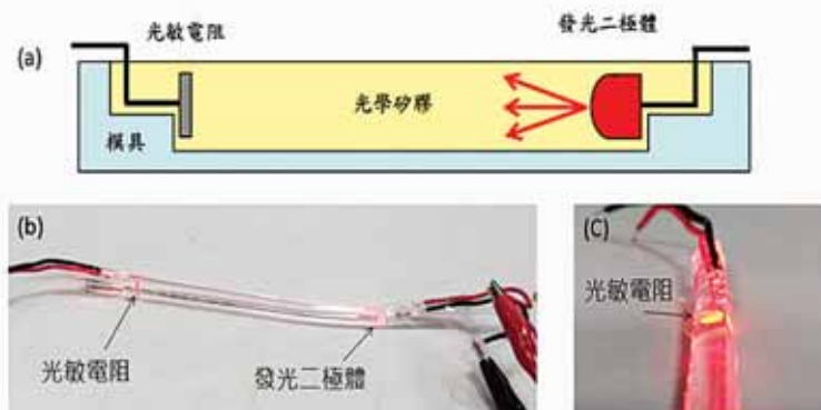
圖2. 整合式彈性波導製程示意圖與實體圖。(a)波導製程示意圖；(b)整合式彈性波導實體；(c)紅光經波導傳遞照射至光敏電阻表面。
