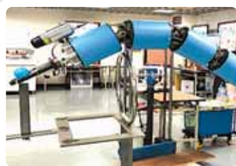
圖5. 機器臂騰空避開障礙物
