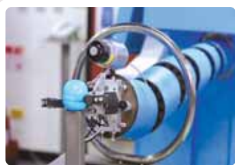
圖4. 機器臂直線穿越障礙物
