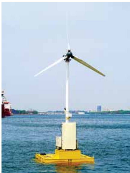
圖4. 浮動式縮尺風機實海域測試
