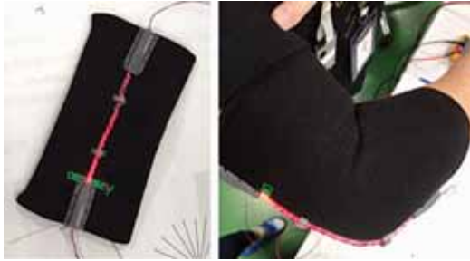
圖3. 整合彈性波導之護肘實體圖
