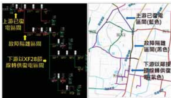
圖2. SCADA(左)完成轉供復電之情境於GIS(右)以不同顏色呈現饋線上各區段運轉狀態
