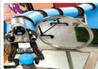
圖6. 機器臂轉彎避開障礙物
