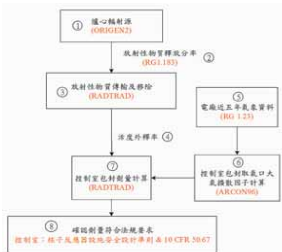
圖1. AST輻射劑量分析流程圖
