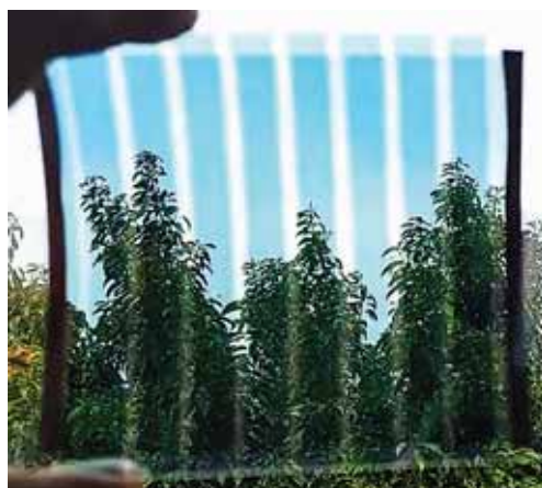
圖2. 核研所開發之可透光軟性有機太陽電池模組
