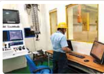
圖8. 人員遠端遙控機械臂
