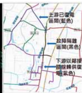
圖2. SCADA(左)完成轉供復電之情境於GIS(右)以不同顏色呈現饋線上各區段運轉狀態
