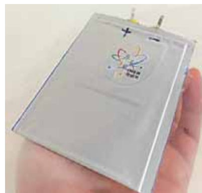
圖3. 左圖：鋁塑膜封裝之膠固態鋰電池充放電曲線，右圖：膠固態鋰電池樣品照片
