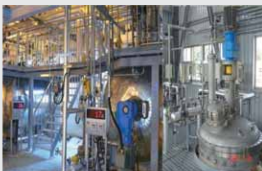
▲ 纖維酒精同步水解及發酵(SSF)生產程序
