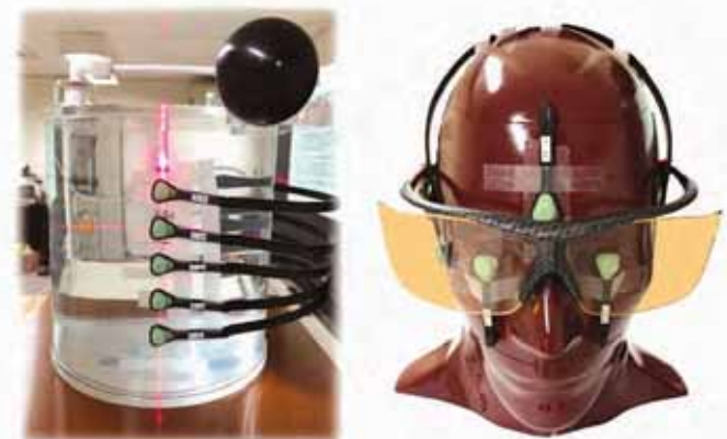
圖5. 不同劑量計間距及佩戴鉛眼鏡對照射結果影響之特性研究
