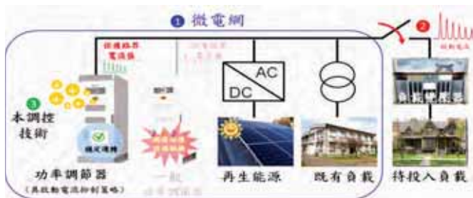
圖5. 用於微電網孤島模式之電壓控制系統應用情境
