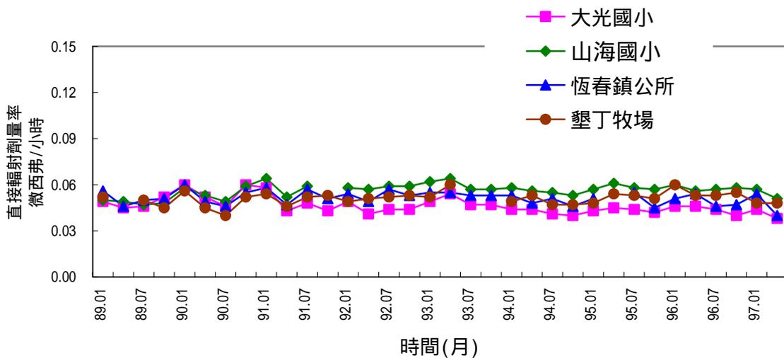
圖 2.6 核能三廠環境主要方位熱發光劑量計季平均劑量率變動圖
