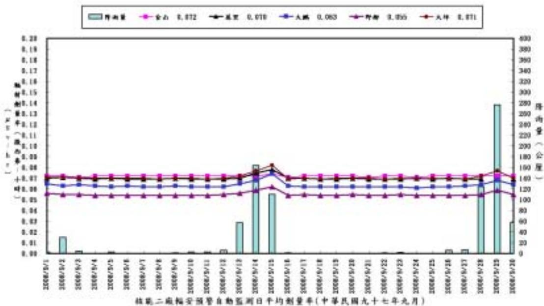
圖 2.2 核能二廠環境輻安預警自動監測日平均劑量率變動圖
