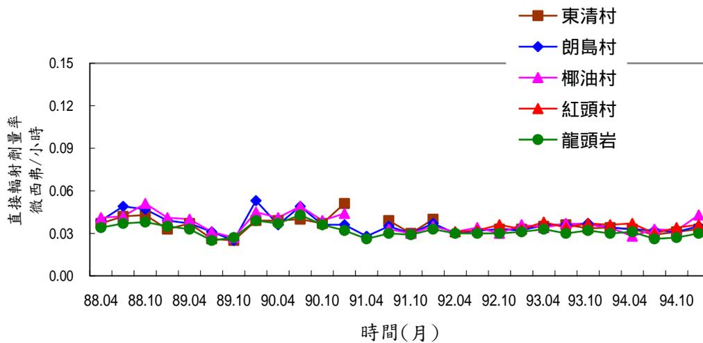
圖 2.22 蘭嶼地區主要方位熱發光劑量計季平均劑量率變動圖
