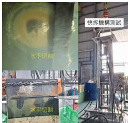
圖4. 水下圓盤鋸模擬測試
