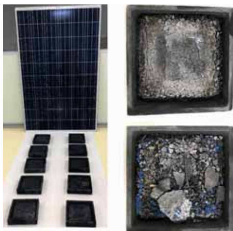
圖3. 太陽光電模組熱裂解處理後樣態
