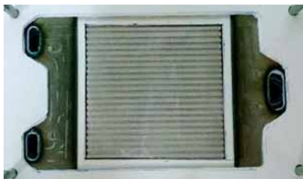
圖5. 玻璃陶瓷密封薄帶應用於電池堆封裝
