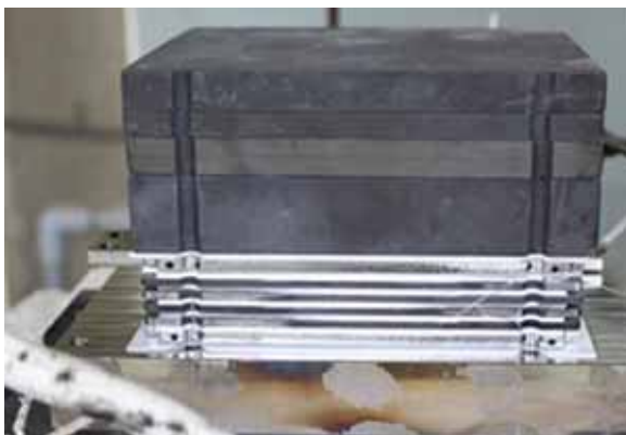
圖2. 核研所自製5片裝MSC電解堆
