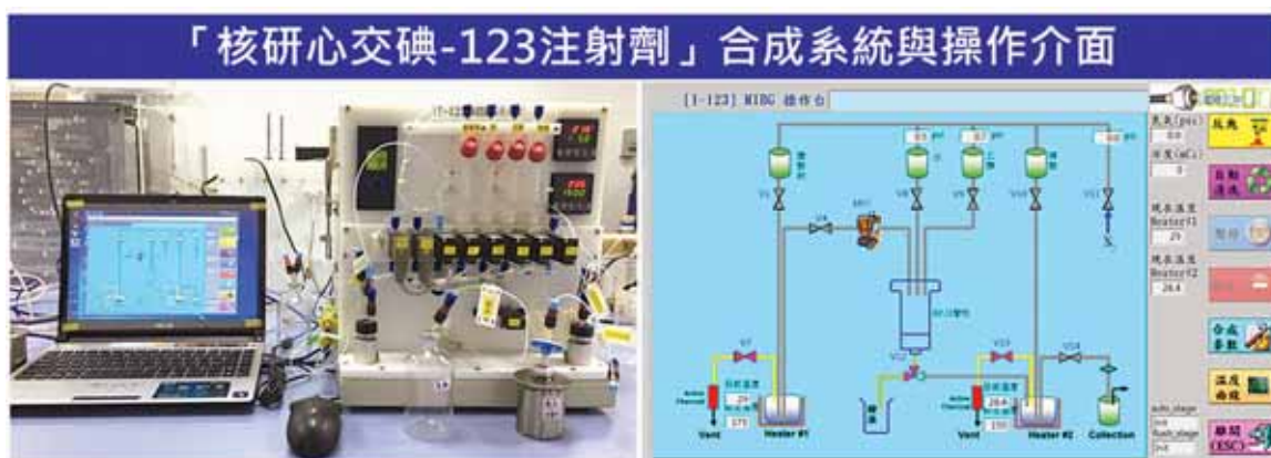
圖2.「核研心交碘-123注射劑」合成系統與操作介面
