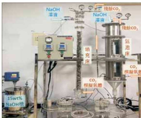
圖2. 實驗型二氧化碳碳酸化測試裝置
