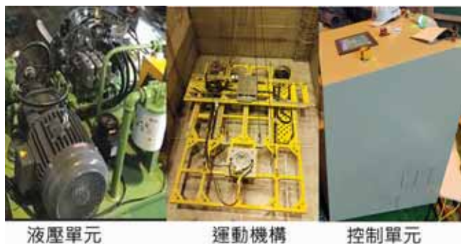
圖3. 水下切割整合工作平台組成
