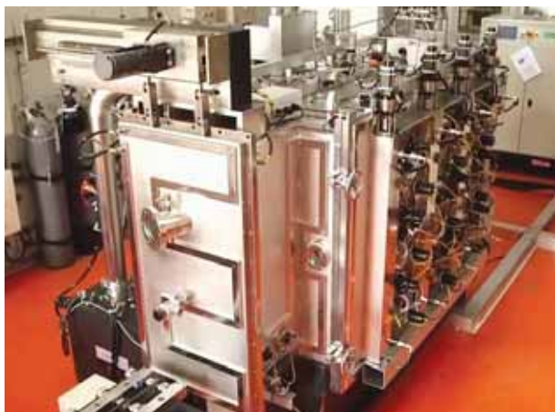
圖2. 低成本量產電致變色快速鍍膜製程機台
