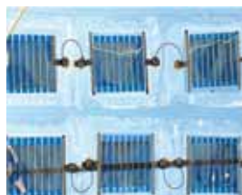
圖2. (a)南北向之隧道型溫室(b)模組貼合於弧形屋頂(c)串聯之模組於兩側金屬電極端點處相接固定(d)OPV與矽晶太陽電池之逐日發電情形
