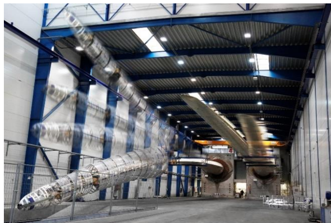
圖 6、疲勞測試示意圖 資料來源：LM wind power 官網
