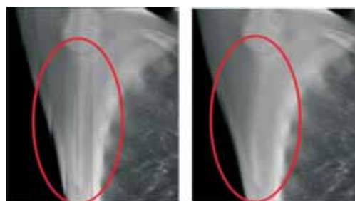
(a)邊緣假影 (b)假影抑低後 圖4.偵檢器邊緣假影抑低演算法
