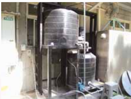
煉鋁爐渣提取氫氧化鋁反應
