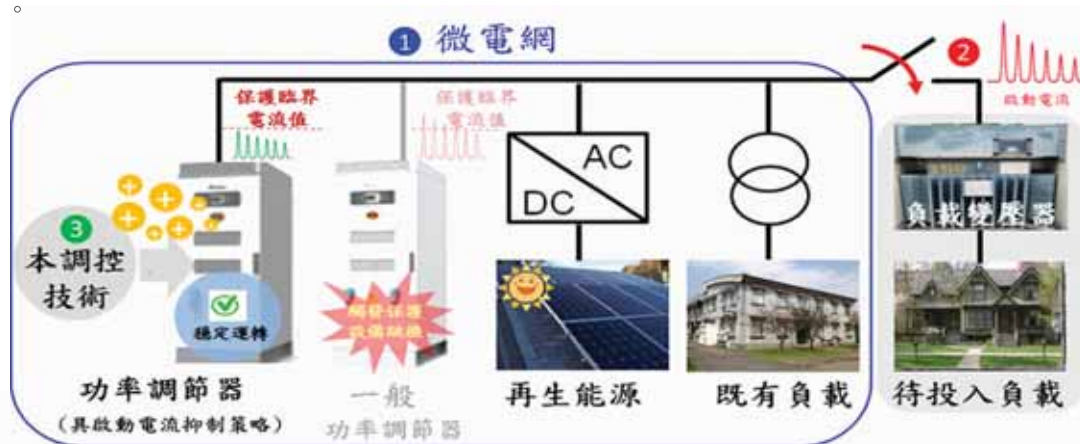
圖1. 用於微電網孤島模式之電壓控制系統應用情境
