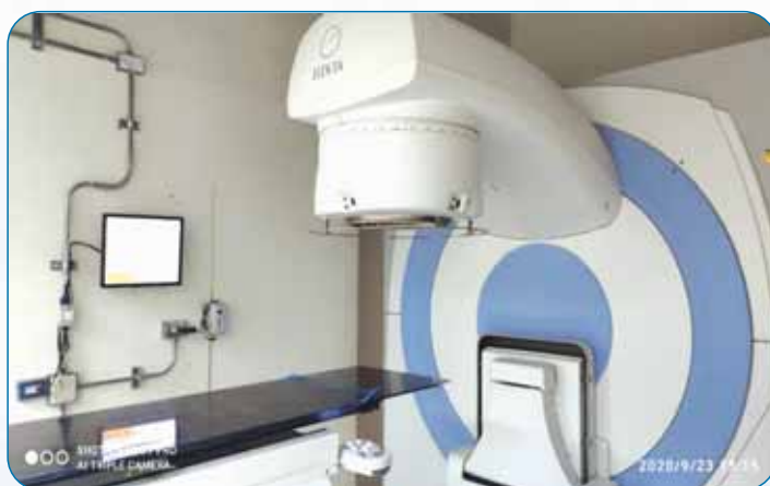
國原院國家游離輻射標準實驗室 直線加速器光子劑量校正系統
