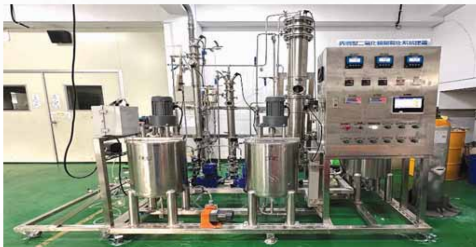
二氧化碳捕捉與碳酸化轉化再利用系統
