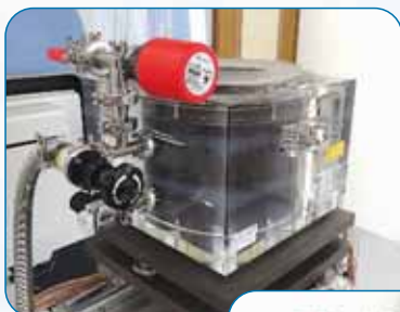
國原院國家游離輻射標準實驗室 自行研製之石墨熱卡計系統
