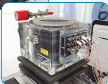
國原院國家游離輻射標準實驗室 直線加速器光子劑量校正系統
