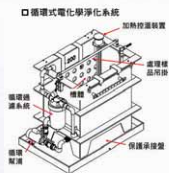
圖3.循環式電化學淨化系統
