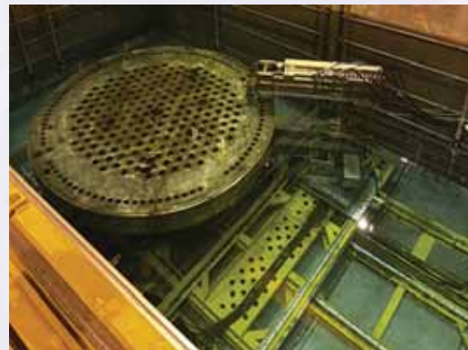
高輻射劑量率組件水下切割
