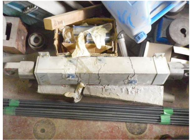
圖二十九 動態荷重與疲勞試驗機與其試體
