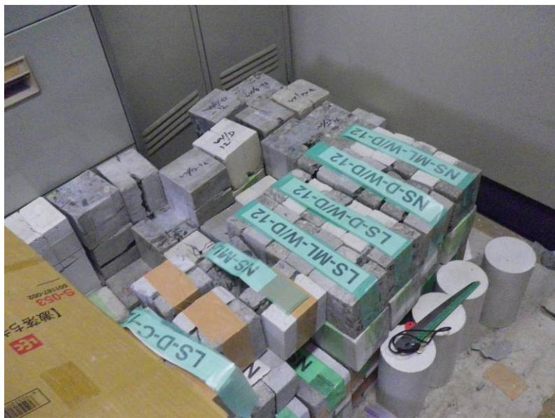
圖二十六 修補材料黏結測試試體
