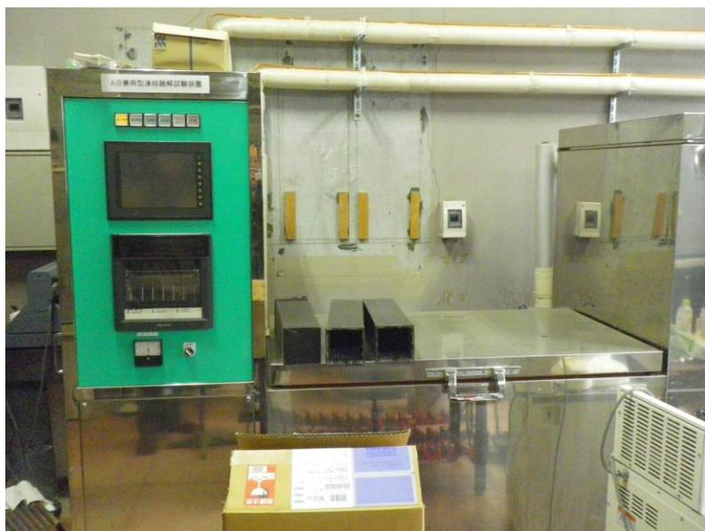
圖二十八 凍融模擬試驗機
