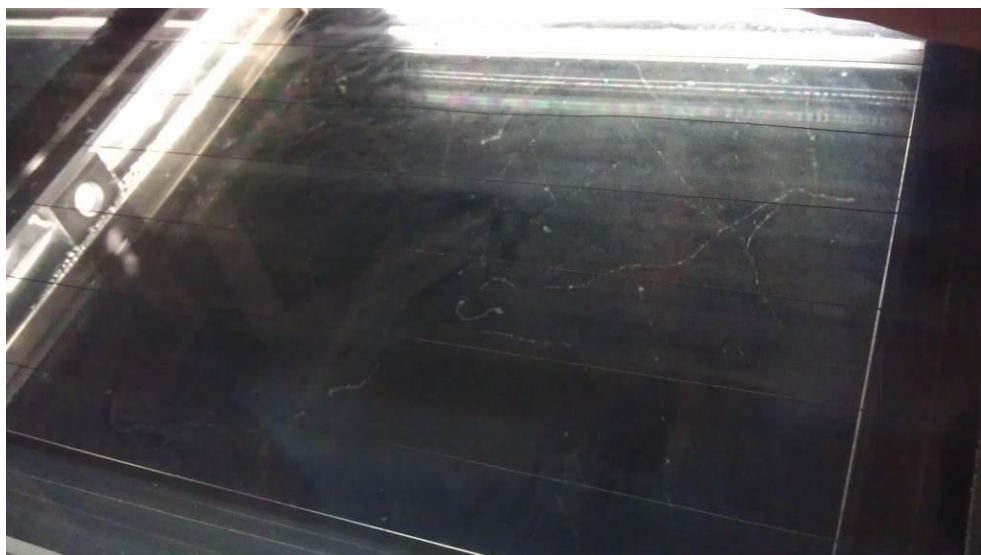
圖 20. 在 Cloud Chamber 內現形之輻射線
