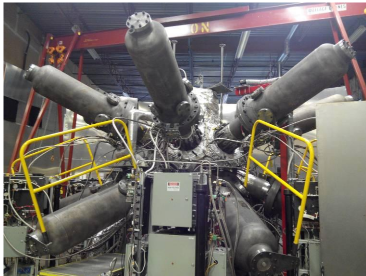
圖 18. 小型漩渦壓縮器及 Acoustic Drivers
