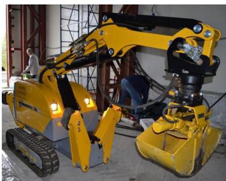
圖一：多功能遙控作業機
