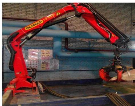
圖二：遙控油壓機械手
