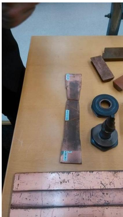
圖 19 焊接完成後進行拉力試驗之試片結果
