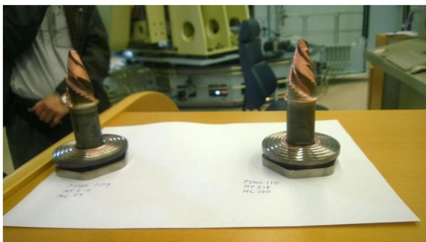
圖 18 螺旋摩擦焊接頭
