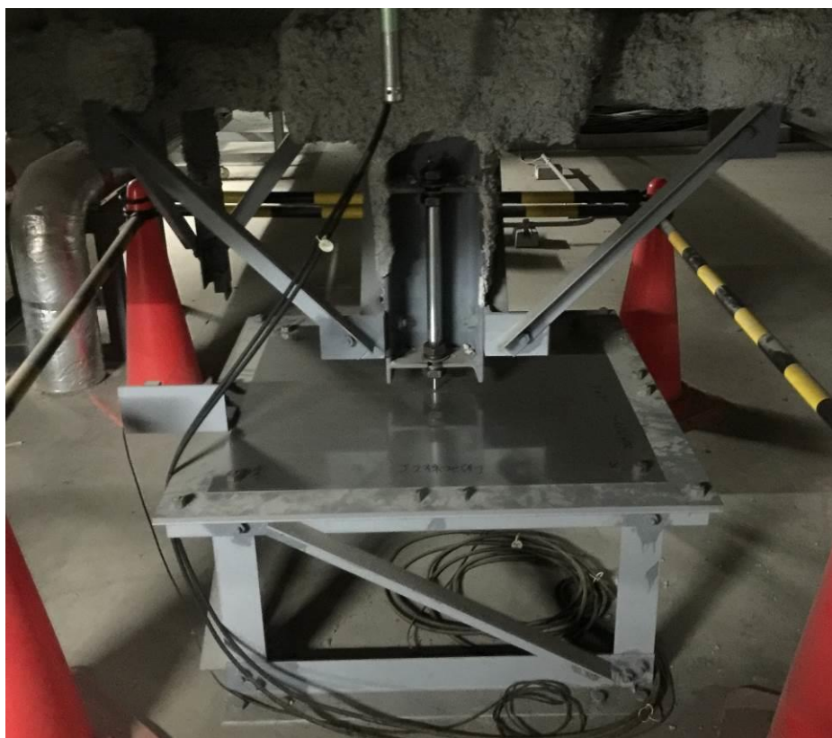
圖 37 震動軌跡測繪的平板
