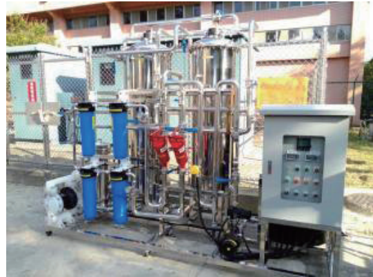
▲ 抽 / 處理 / 灌試驗設備
