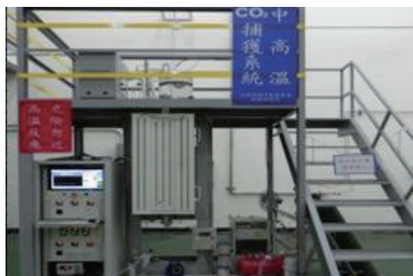
▲ 圖 2-4、INER 研發 10 kW 固定床反應器
