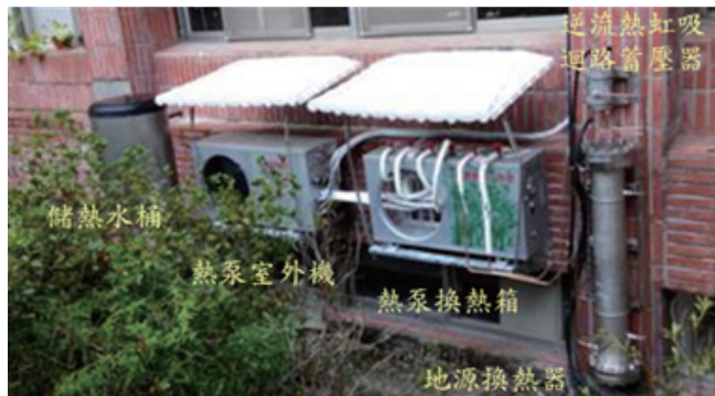
▲ 圖 10. RLT 地源熱泵實驗測試平台
