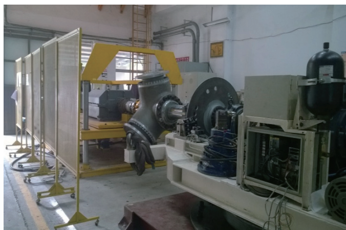
▲ 圖 2：150 kW 風機地面測試
