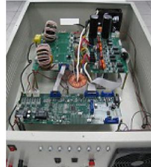
▲ 圖6 具高效率及併網/孤島平穩切換之單相5 kW電力轉換器
