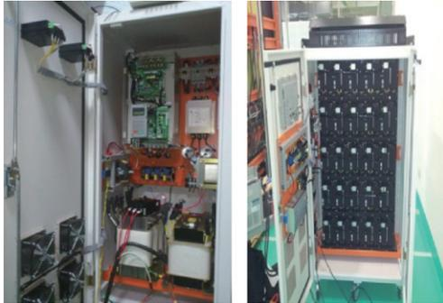
▲ 圖4 具實/虛功與充/放電控制技術之三相 15 kW電力轉換器
