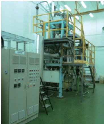
▲ 圖4 流動式顆粒床過濾器熱模系統
