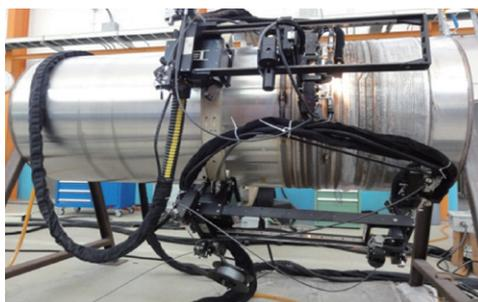
▲ 熱端管路覆鋸設備
