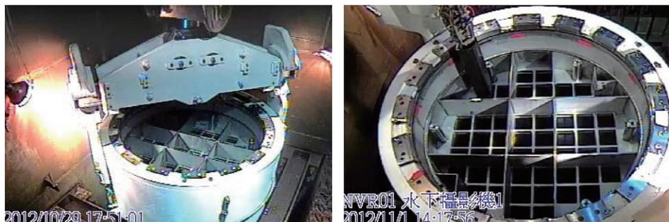
▲ 圖5 核一廠水下吊運測試 (左)，假燃料水下裝載測試(右)。
