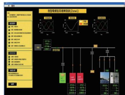
▲ 圖3 微電網單獨/併網平穩切換展示功能測試
