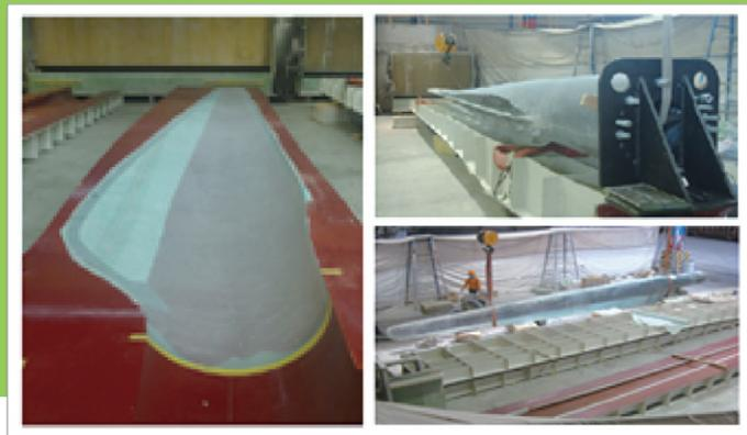
▲ 圖10 二代葉片製造與測試過程
