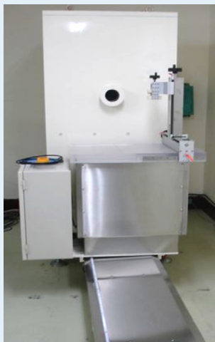
▲ 利用Co-60廢射源製作之衰減式射源照射裝置
