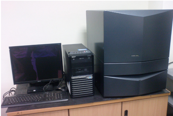
▲ 三光電管液體閃爍計數儀
