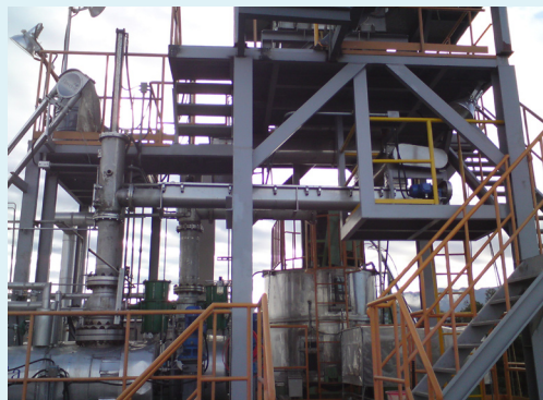
▲ 噸級廠連續式酸催化前處理系統
