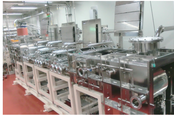
▲ 實驗型捲揚式金屬捲PECVD系統
