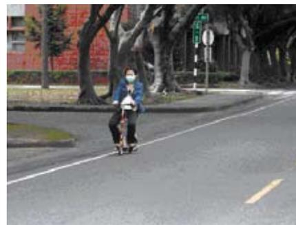
▲ 以Pt/AC儲氫匣推動120 W的滑板車系統，可運作14分鐘。
