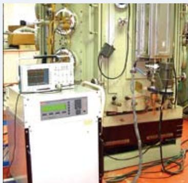
▲ 高功率脈衝磁控濺射鍍膜系統
