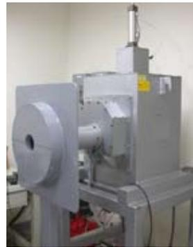
▲ 自製之 $^{137}\text{Cs}$ 輻射照射器與準直儀
