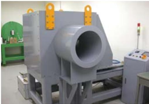
▲ 屏蔽式低背景散射之輻射量測儀器校正設備
