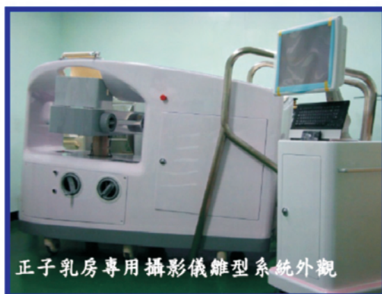
▲ 乳房專用正子攝影儀離型系統及乳房假體造影結果 (F-18-FDG, without attenuation correction)。
