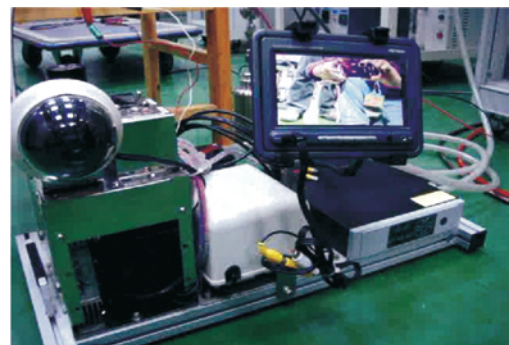
▲ 以Pt/AC儲氫匣推動75W的監控系統。
