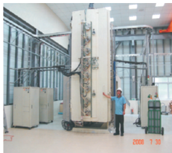
▲ 直立式被覆爐( \phi 1300mm x H 5000 mm)安裝在岡山鎮本洲工業區環保科技園區廠房
