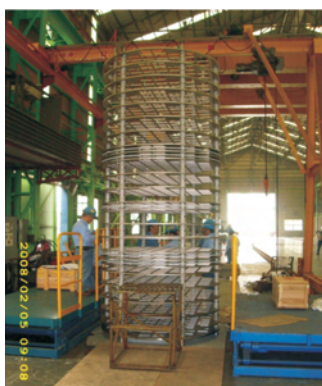
▲ 測試用鋼筒製造－提籃組裝
