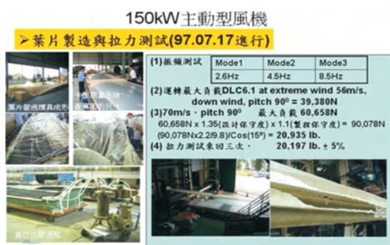
▲ 150kW風機葉片製造與拉力測試
