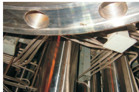
(b) RIP的馬達Casing法蘭面有弧擊
