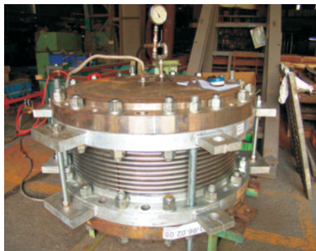
▲ 金屬膨脹接頭水壓測試
