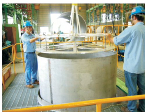
▲ 密封鋼筒製造－鋼筒外殼 go gauge 測試
