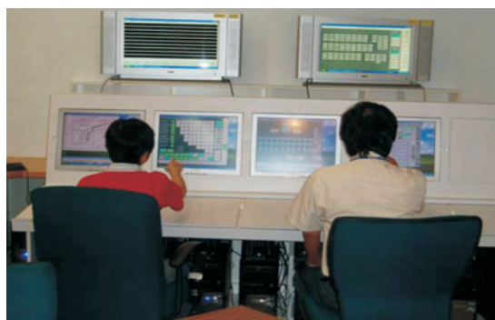
▲ 核四廠數位儀控系統人機介面驗證測試
