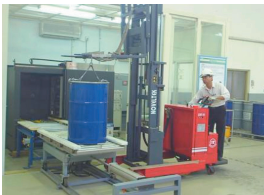
▲整桶加馬比活度量測系統
