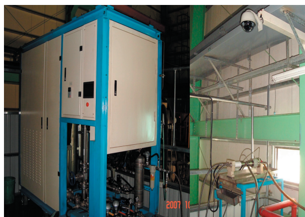
▲蒸汽電漿火炬長時測試與監控系統
