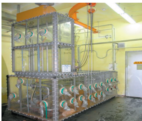
▲016館Unit20手套箱完拆除前
