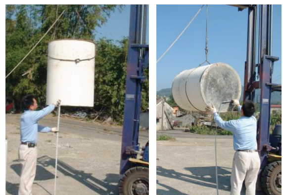
▲高效能混凝土承裝容器之機械強度測試
