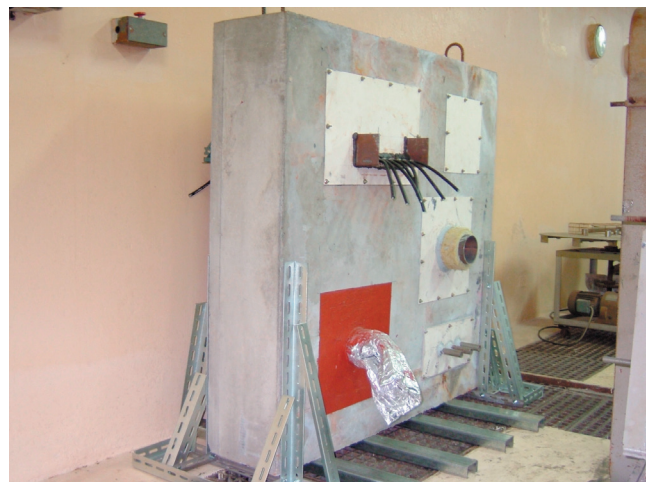
▲輻射照射廠接受委託耐火材老化照射試驗(劑量1000kGy)
