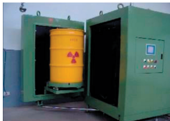
▲整桶加馬總比活度量測系統
