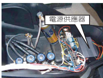
▲圖2 小型高壓高頻電源供應器及控制元件
