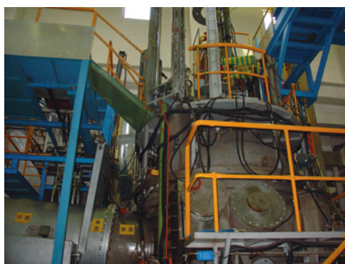
▲低放射性廢棄物電漿熔融爐
