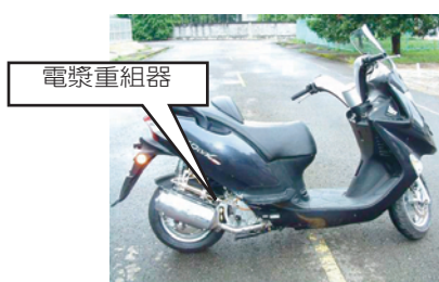
▲圖1 電漿氫—汽油混合燃料雛型機車
