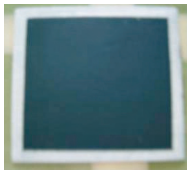
▲(5) INER-SOFC單元電池(5×5 cm²)
