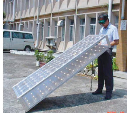
▲聚光模組戶外實驗(聚光倍率546倍)
