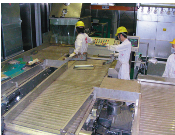
▲除污設備前置分類操作情形
