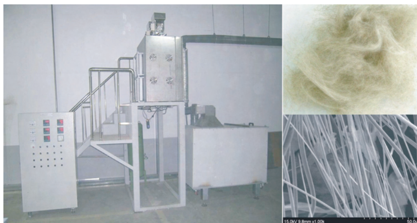
▲岩礦纖維製作設備及試製產品
