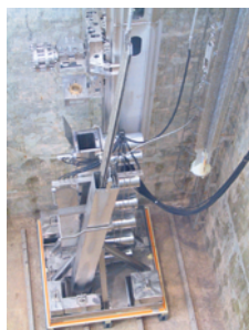
▲控制棒葉片模擬擠壓後情形
