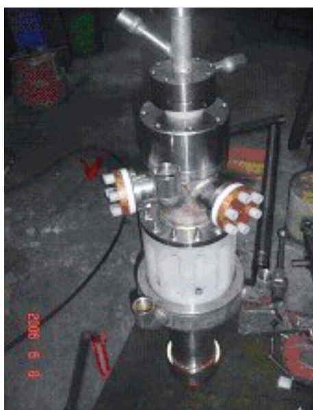
▲圖1 600kW非傳輸型蒸氣直流電漿火炬
