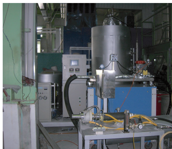
▲20kW蒸汽電漿火炬系統
