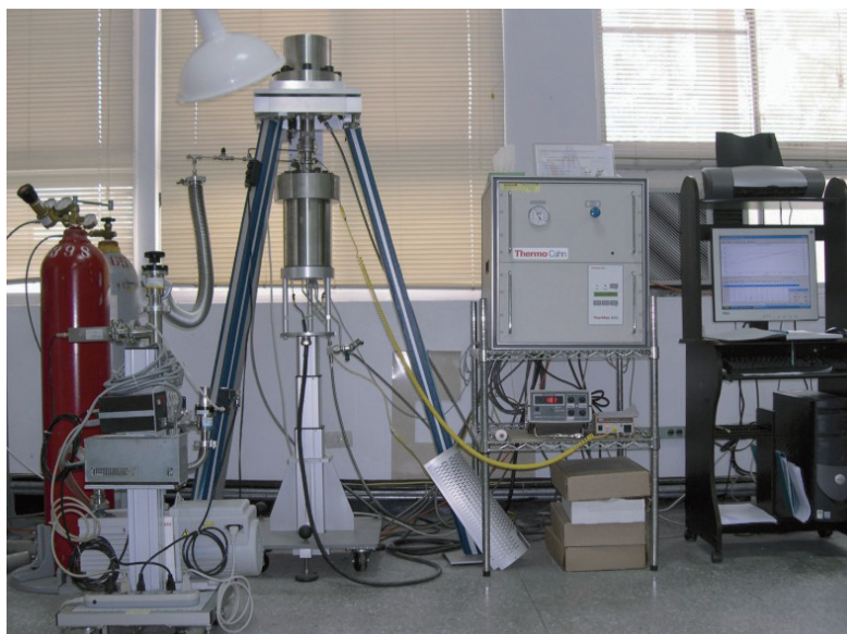
▲本所建立之高壓熱重量分析（TGA）系統
