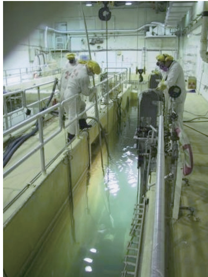
▲鈾粉收集沈澱槽
