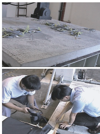
▲利用乾點式探頭對鋼筋混凝土版破壞狀況，進行掃描。
