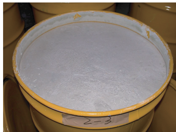
▲高減容固化系統試車製作之固化體
