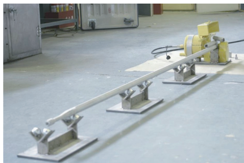
◀燃料棒剪斷器操作模擬
