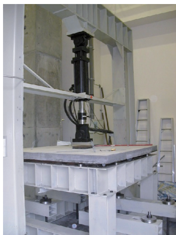
▲利用乾點式探頭對鋼筋混凝土版破壞狀況，進行掃描。
