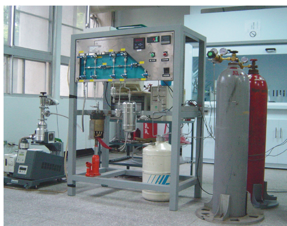
▲Sievert氣體體積量測法
