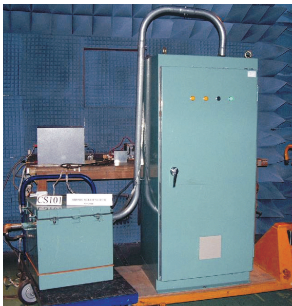
▲核電廠強震急停裝置驗證測試
