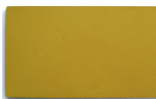
品名：微晶材料 主原料：水淬熔岩95% 副原料：Binder (PVA) 5% 鍛燒溫度：1150°C
