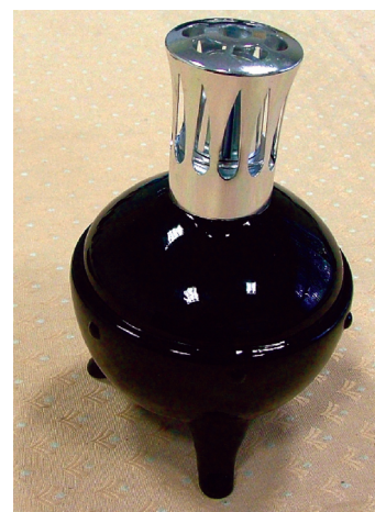
品名：藝術品 原料：電漿熔岩50% 副原料：廢玻璃50% 溫度：1200°C 成形方式：鑄模澆注
