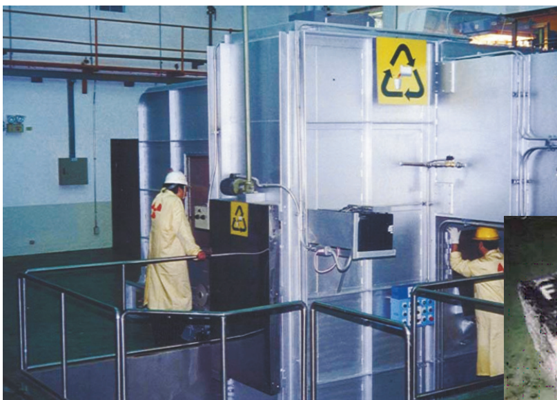
▲污染金屬廢棄物專用感應熔爐
