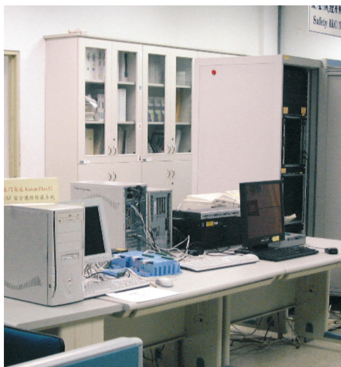
▲核四廠 DRS Plus32 安全儀控系統測試平台
