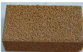
品名：透水磚 主原料：水淬熔岩100% 副原料：Binder、釉料 鍛燒溫度：900°C
