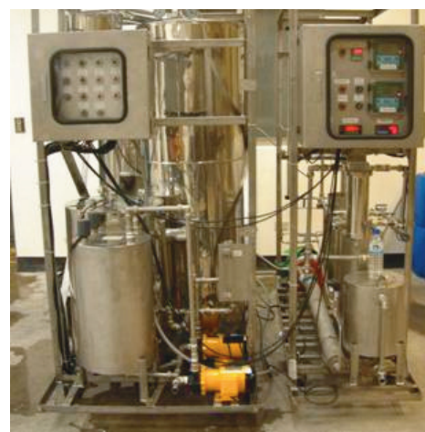
▲移動式廢水純化及回收再利用先導系統設備
