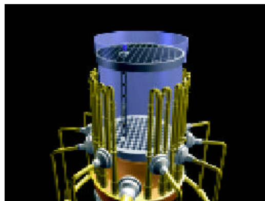
■爐心側板焊道檢測
