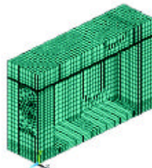
■水平貯存模組(HSM)有限元素分析模型
