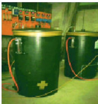
■100公升級可保溫絕熱式生物發酵反應槽
