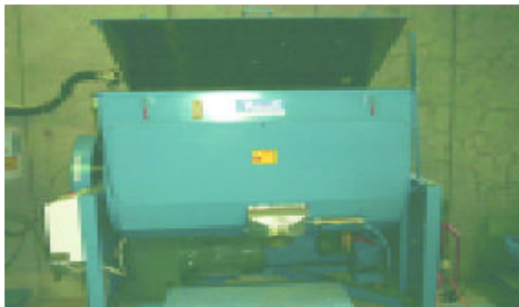
■1000公升級可調控定溫、給氧生物發酵反應槽
