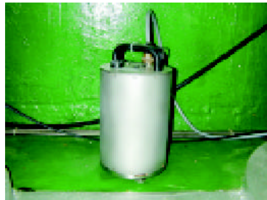
■寬頻地震觀測配備之地震感測器
