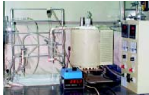
■ \text{TeO}_2 / ^{131}\text{I} 乾法蒸餾分離程序設備
