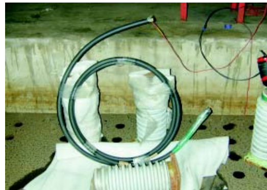
■ 電纜耐電壓測試
