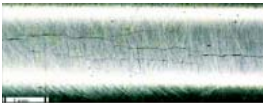
■ 蒸汽產生器管表面之應力腐蝕裂縫
