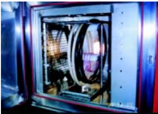
■ 電纜熱老化測試
