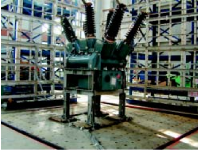
■ 中興電工 69 kV GCB 斷路開關耐震測試於國家地震中心地震平台
