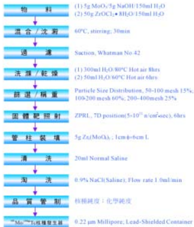
■利用合成鉬酸鋯為照射靶製備 99 Mo/ 99m Tc核種發生器之化學程序流程
