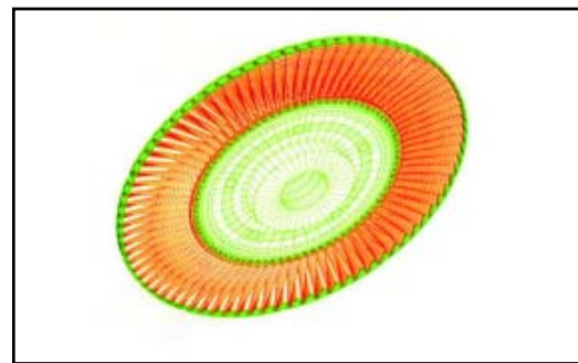
■ 含葉片輪盤之有限元素網格
