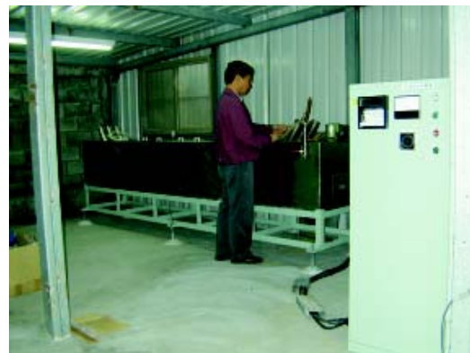
■ 電纜介電損失及靜電容量測試
