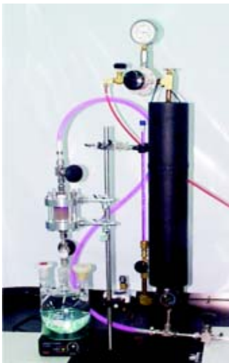
■ 混合回填材料之管柱透水試驗裝置
