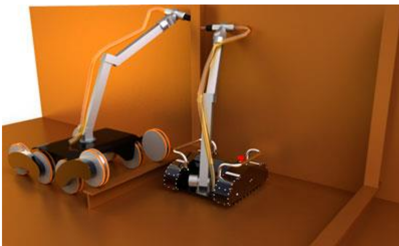
圖 3.2.6 水平式混凝土護箱檢測設備
