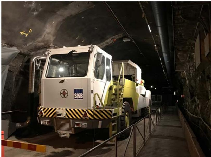
圖 41、設施載運廢棄物罐工程車
