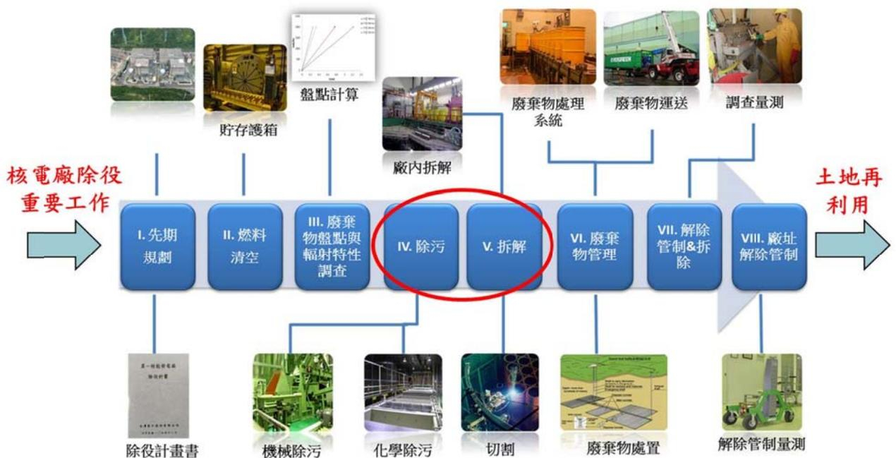
圖 1、大型核能設施除役流程及技術需求
