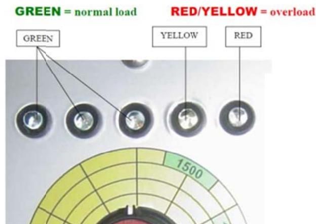
圖 7、圓盤鋸操作面板上的燈號
