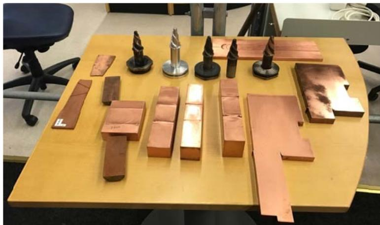
圖 37、摩擦攪拌銲接法鑽頭與銲接成果展示
