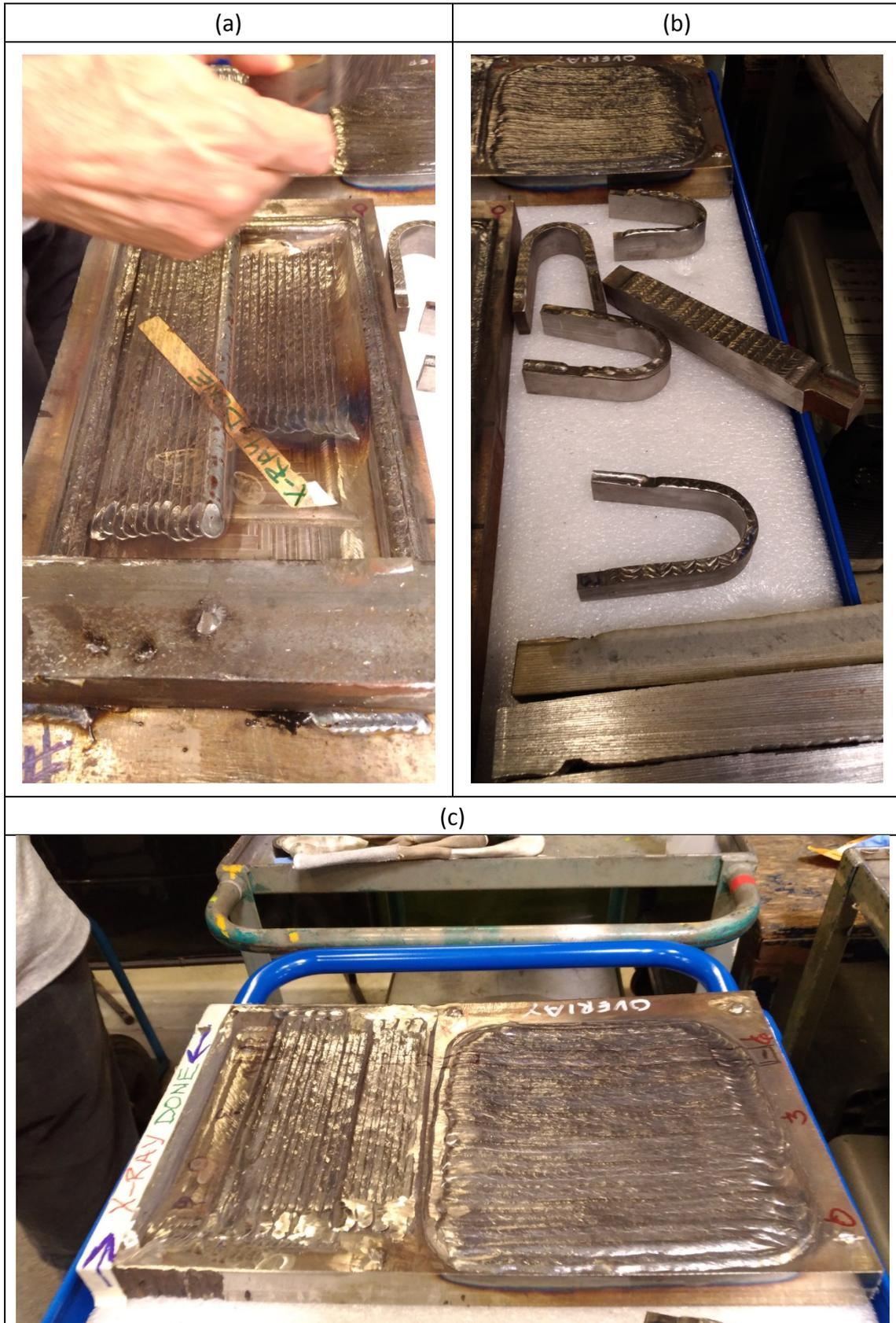
圖 13 (a)HY-80 鋼板修補測試試片；(b)彎曲測試結果；(c)執行 X-ray 檢測。
