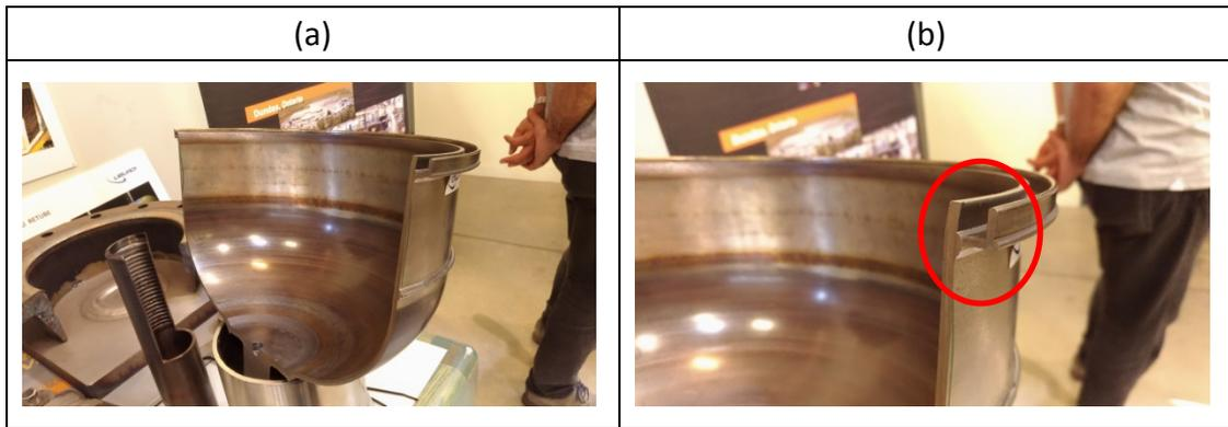
圖 11 部份積層之鈦合金槽體: (a)槽體剖面；(b)積層製造部位。
