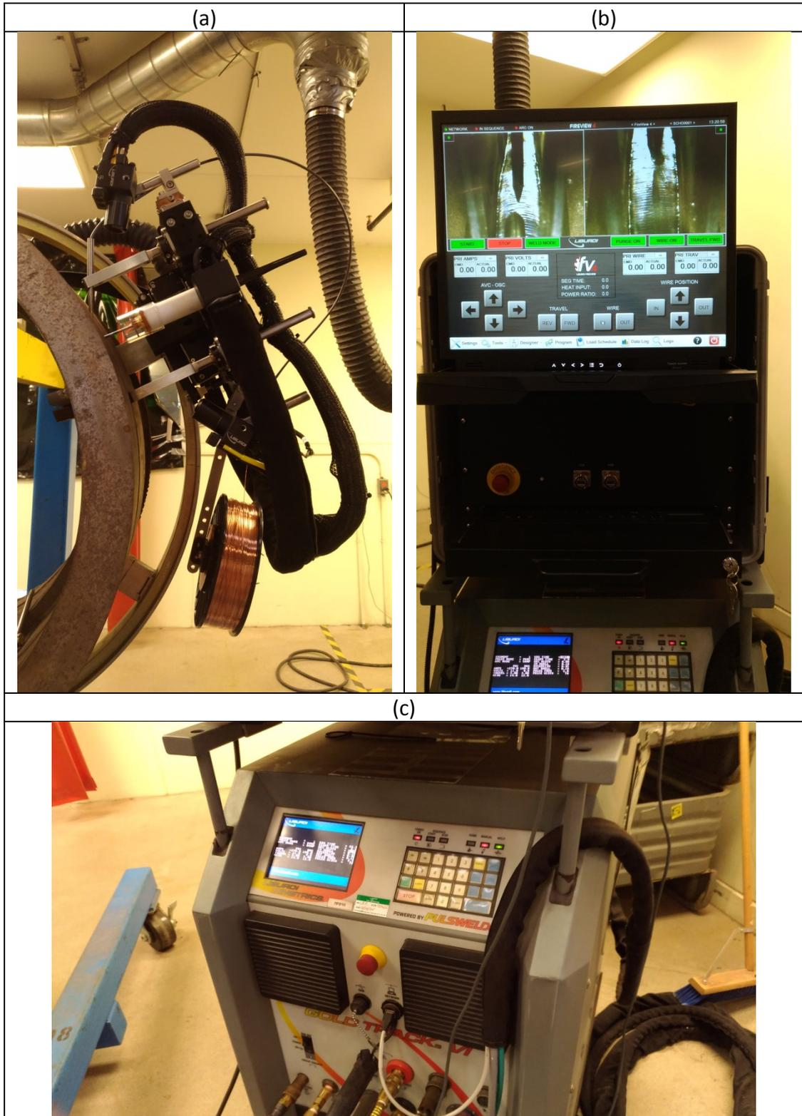
圖 6 LAI 軌道式氬銲機: (a)銲頭；(b)銲道監視系統及(c)銲機。
