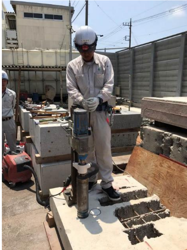
圖 65 鋼筋混凝土塊之乾式鑽孔取樣過程
