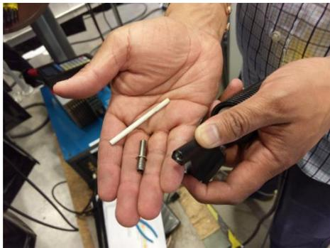
圖 14 送線機構拆解
