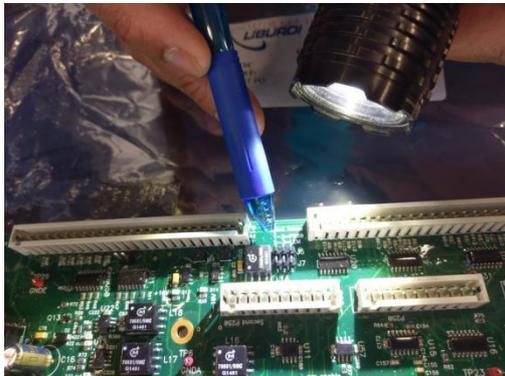
圖 7 講解 Tripoli Board 及 Jumper 設定
