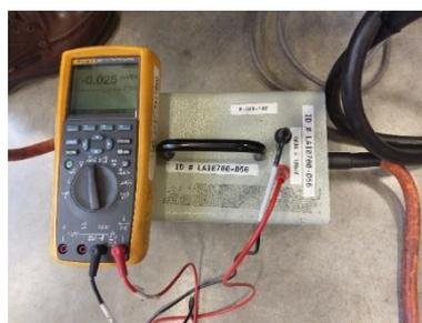
圖 16 設備 Load Bank 外觀 圖 17 搭配 Load Bank 需使用到 Shunt 及電表
