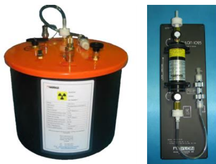
圖 3 固體鐳-226 標準射源(RN-105A,左圖)及固體鈷-228 標準射源(TH-1025,右圖)
