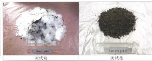
圖 5、PHAs 生物分解性評估試驗結果
