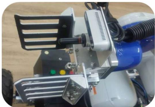
圖 7、電動雙片式夾爪搭載深度相機與輻射偵檢頭
